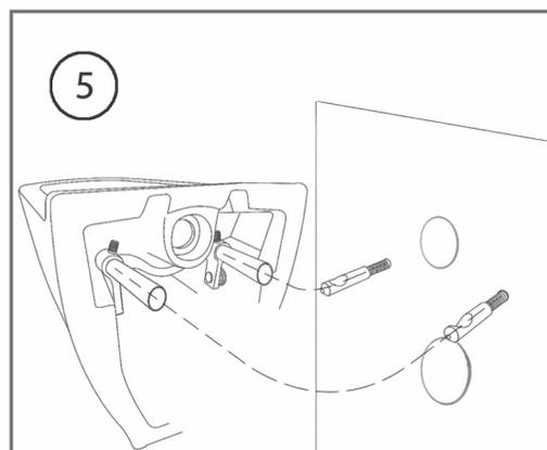
5 Setzen Sie das WC vorsichtig auf die Wand-Trägerschrauben und schieben Sie es bis zur Wand. Die Kunststoff-Führungshülsen erleichtern diesen Schritt.
