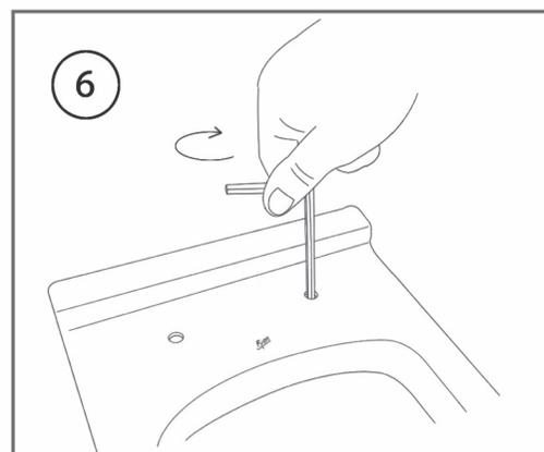
6 Ziehen Sie die Fixierschrauben mit Hilfe eines Inbusschlüssels durch die oberen Bohrungen fest
