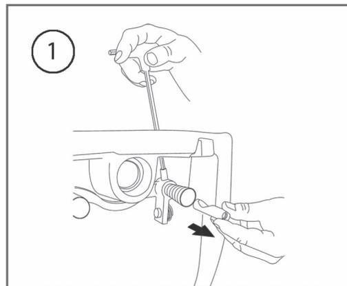
1 Entfernen Sie mit Hilfe eines Inbusschlüssels die 2 Trägerbolzen (5) durch lösen der beiden Fixierschrauben (4), jedoch nicht ganz heraus-schrauben. **Entfernen Sie keinesfalls die Kunststoffhülsen** (sie dienen zum leichteren draufschieben des WC auf die Trägerbolzen)
