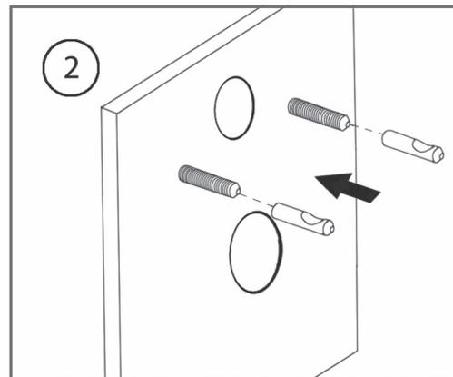
2 Schrauben Sie die Trägerbolzen auf die Wand-Trägerschrauben ein Stück weit drauf
