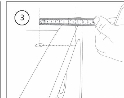
3 Messen Sie den Lochabstand der Bohrungen zum hinteren Abschluss des WC.
