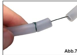
7. Draht in der Kerbe legen und etwas umwickeln (Abb. 7)
