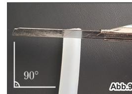
9. Strang aus altem und neuem Schlauch von oben durch die Dichtung schieben. Gleichzeitig unten am Draht ziehen, bis der neue Schlauch zum WC reicht. **Dichtung nicht beschädigen!**
