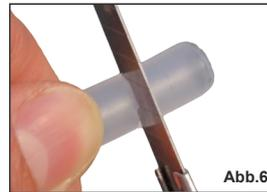
6. Kleine Kerbe an einem Ende des neuen Schlauchs schneiden (Abb. 6)
