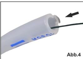
4. Einen Draht durch das obere Ende des alten SLS-Schlauchs bis zum unteren Schlauchende durchschieben. Damit ist eine zugfeste Verbindung geschaffen, auch wenn der alte Schlauch beim entfernen unterbrochen werden sollte (Abb. 4)
