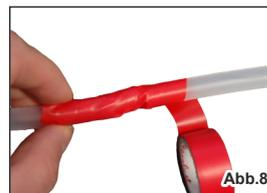
8. Schläuche zusammenschieben und mit etwas Klebeband umwickeln (Abb. 8)
