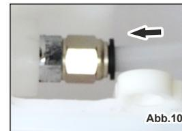
10. Klebeband entfernen, Draht vom neuen Schlauch lösen und alten Schlauch entfernen.
