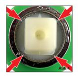
Achten Sie unbedingt darauf, den Ring gerade und ohne zu verkanten aufzusetzen (Abb. 4). Lässt die der Ring nicht leicht drauf schieben, so sitzt er nicht korrekt (Abb.5).
